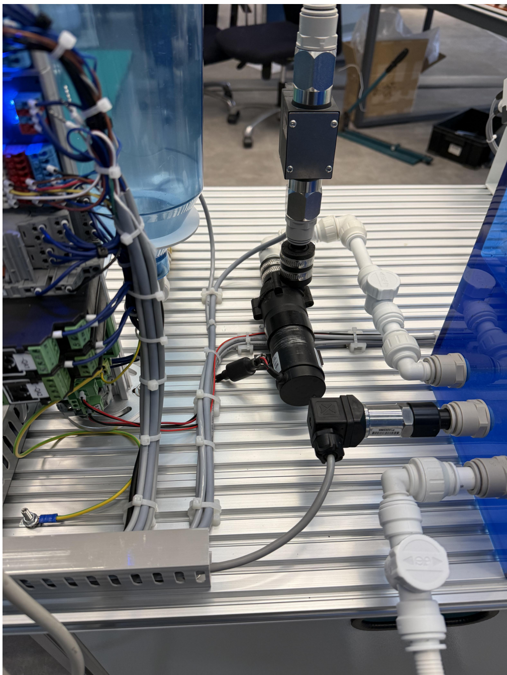
水的净化单元与水的输送单元之间的连接（局部图）
